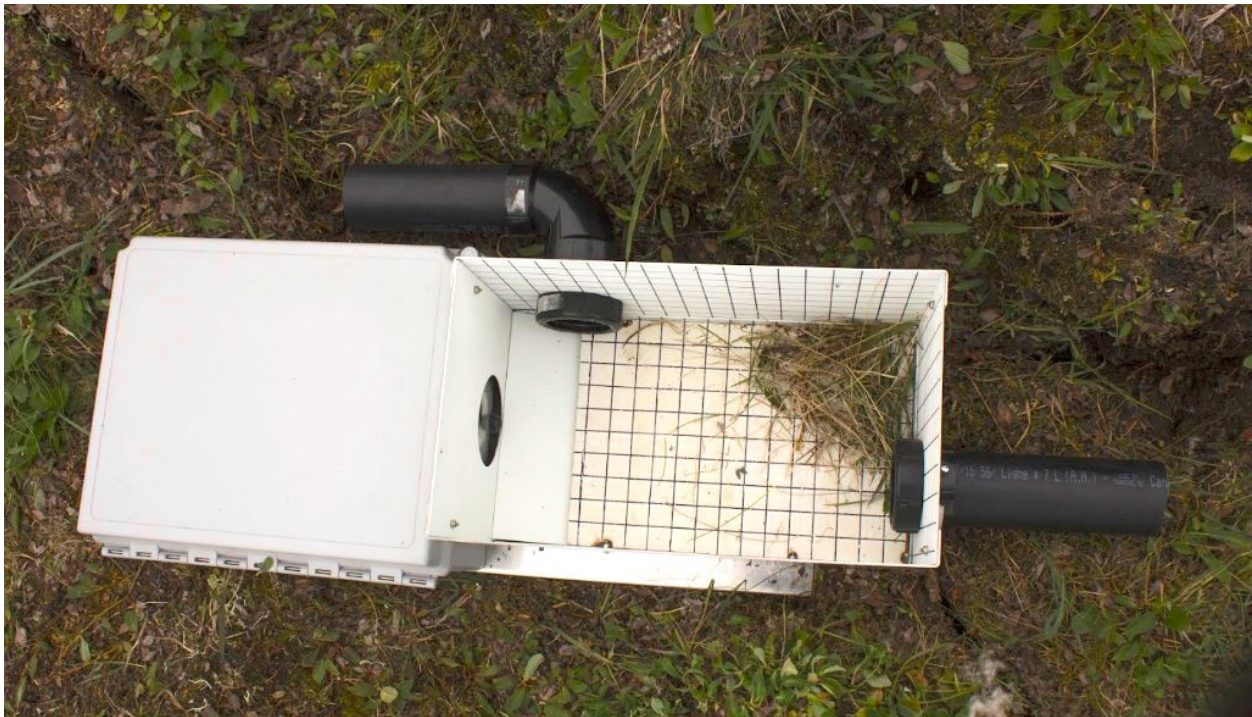
Vue en plongée du dispositif de monitoring des lemmings. La boîte de gauche contient les composantes électroniques, la batterie et la caméra infrarouge. Le couvercle de la boîte de droite a été retiré pour exposer l'enceinte dans laquelle circulent les lemmings. Les deux courts tuyaux qui donnent accès à l'enceinte sont intégrés, par les lemmings eux-mêmes, à leur réseau de tunnels. © MATHILDE POIRIER
